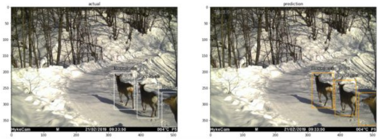
図10 複数の個体と一部しか写っていない状況で検出したケース
